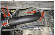
26. Reconnect the Temp. Sensor wiring
